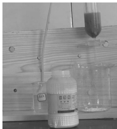
图3 大烧杯中加入硫粉处理汞单质
