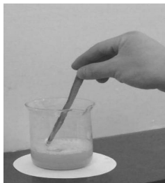
图13 用燃烧着的木条靠近气泡无明显现象
