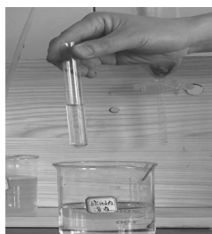
图4 硫化钠检验氯化汞已洗净
