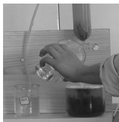
图9 往洗涤液中加入硫化钠溶液
