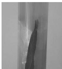
图6 铝与冷水反应表面有气泡冒出
