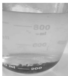
图12 洗涤液底部有灰黑色沉积物
