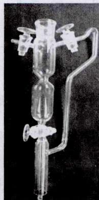
物的洗涤, 或者让固体反应物与一种液体反应后将该液体排空继续与另一种液体反应。反应结束后, 打开玻璃活塞 3, 液体通过排液内管进入烧杯进行废液处理。
